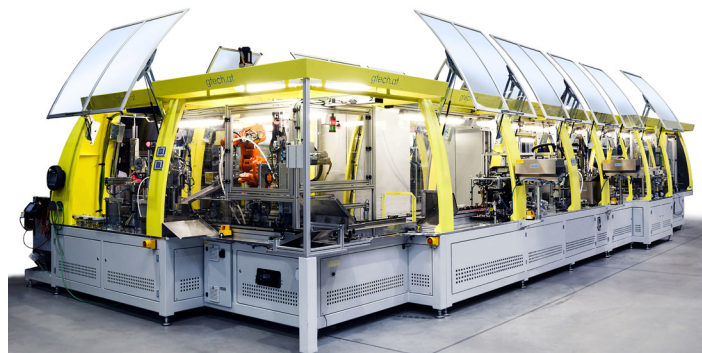
Abb: In dieser vollautomatisierten Montageanlage werden für einen deutschen Automobilhersteller im 18 Sekunden-Takt Wasserpumpen montiert.
