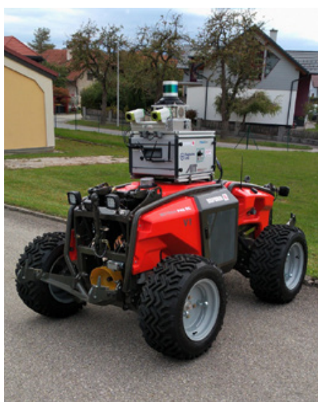
Auf die Plattform Metron der Reformwerke Bauer wurden Sensoren für eine Rundumsicht montiert. Bild: Reform
