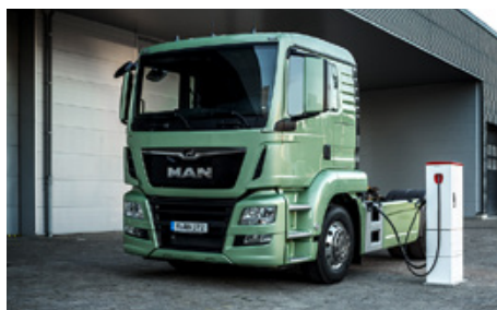
MAN eTruck mit bis zu 150 km Reichweite im städtischen Verteilerverkehr. Bild: MAN
