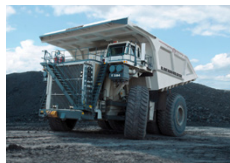
363 Tonnen Nutzlast: Muldenkipper-Gigant Liebherr T 284. Bild: Liebherr
