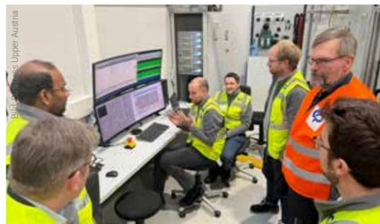
Das Team von Plastic Omnium in Wels demonstriert Christer Thorén (Scania; r. mit orangefarbener Warnweste) die Leistungsfähigkeit der 150-kW-Brennstoffzelle am Prüfstand.
