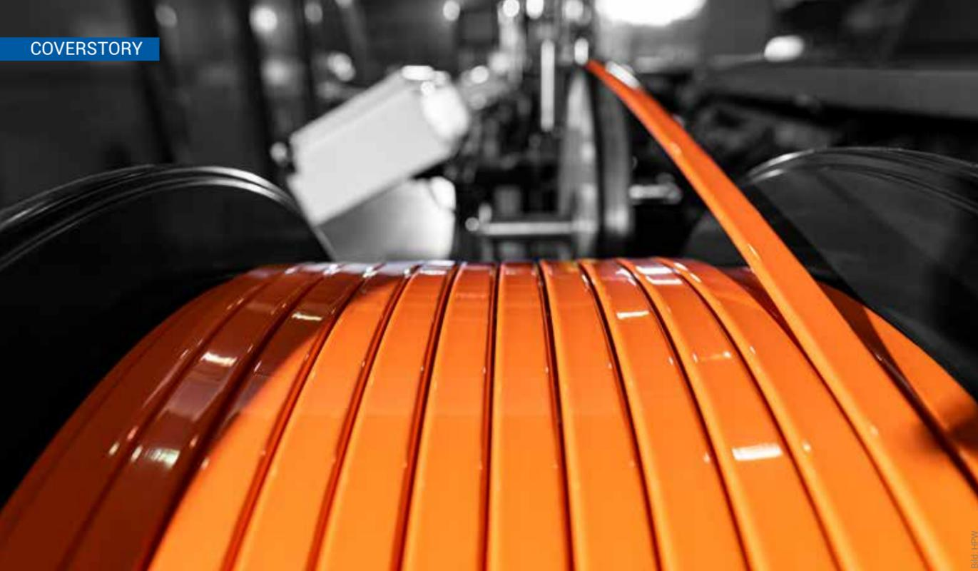
HPW produziert speziell isolierte Flachdrähte, sogenannte Busbars, aus Kupfer und Aluminium als Stromschiene zwischen Elektromotor und Batterie oder zur Verbindung der einzelnen Batterieelemente.
