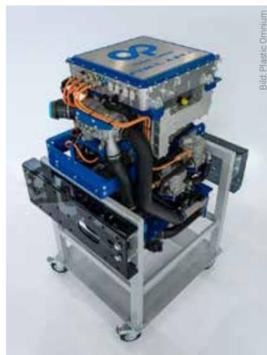
150-kW-Heavy-Duty-Brennstoffzellensystem von Plastic Omnium
