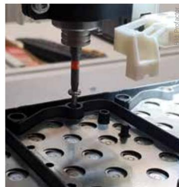
Abbildung 2 b): Roboter-Assistenz beim Lösen von Schrauben
