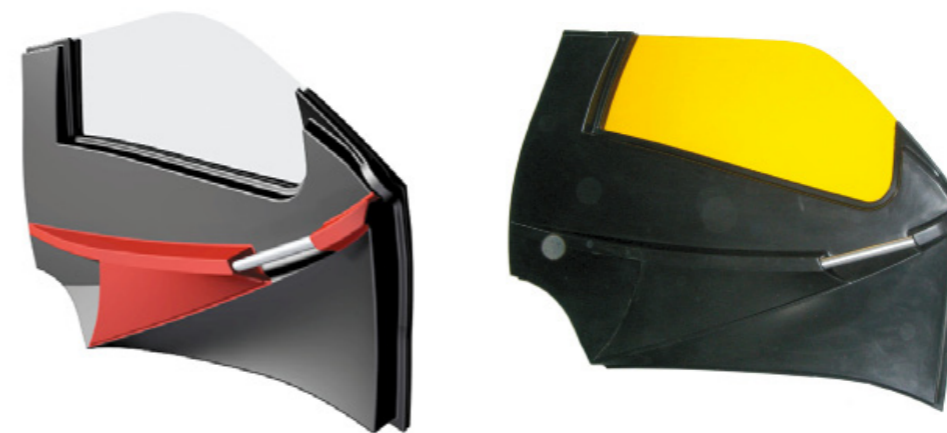
Links: Kunststoffgerecht konstruierte Fahrzeugtür. Rechts: Ergebnis dieses Projektes - eine Fahrzeugtür aus Polypropylen-Sandwichteilen
