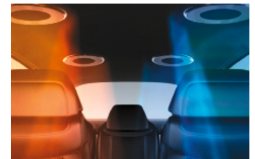
Kühlung von oben: Visteons Vertikal-Klimaanlage
