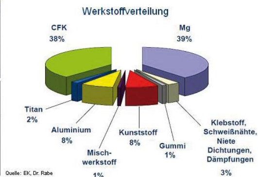
Bild: Materialmix des Volkswagen L1
