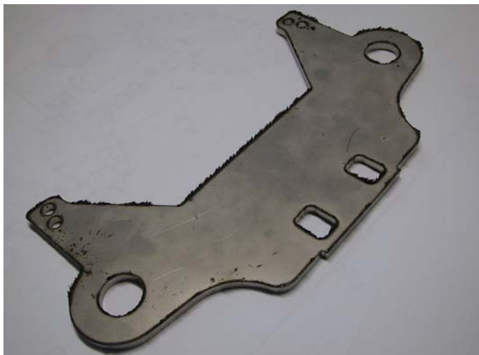
Lasergeschnittenes Metallteil vor der Entgratung, die bisher hauptsächlich händisch durchgeführt wurde.
