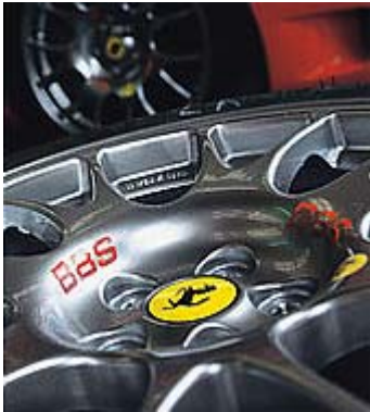
Leichtmetallfelgen werben KFZ nicht nur optisch auf, sondern sorgen auch für Gewichtsreduzierung.
