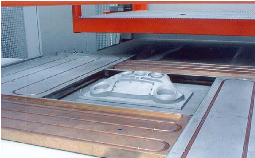
Form in der Tiefziehmaschine
