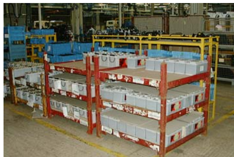
Es werden keine Batterien mehr zwischengelagert sondern direkt ans Band angeliefert.
