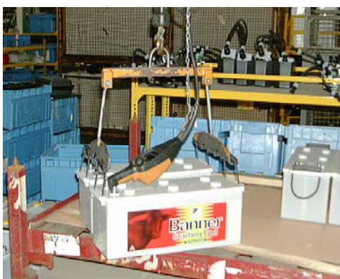
Anlieferung und Einbau direkt am Band
